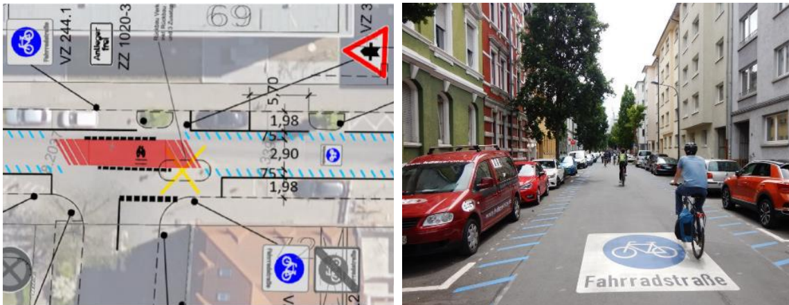
Abbildung 22: Planung Fahrradstraße / eingerichtete Fahrradstraße mit taktilem Sicherheitstrennstreifen zum „Gefahrenbereich Kfz-Türen“ in Offenbach am Main (Quelle: Eigene Darstellung / eigene Fotos)
